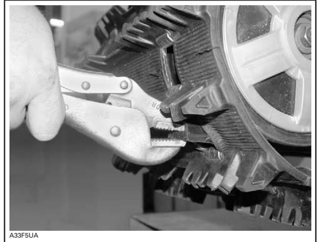
TYPICAL - PULL ON SLIDER SHOE TO REMOVE
